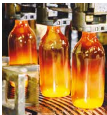
▲ GRAPHITKOMPONENTEN FÜR DIE HANDHABUNG VON HEISSEM GLAS
