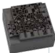
▲ GRAPHITELEKTRODE FÜR DIE PRÄZISIONSBEARBEITUNG
