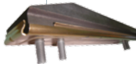
KOHLE-SCHLEIFSTÜCKE FÜR DITTE-SCHIENE STROMABNEHMER ▼
